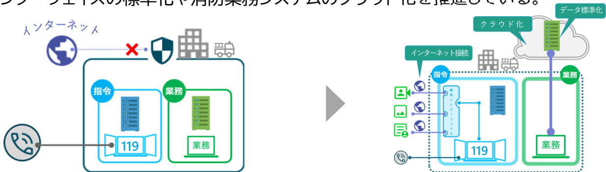
【インターネットに接続されていない独立型の消防システム】
